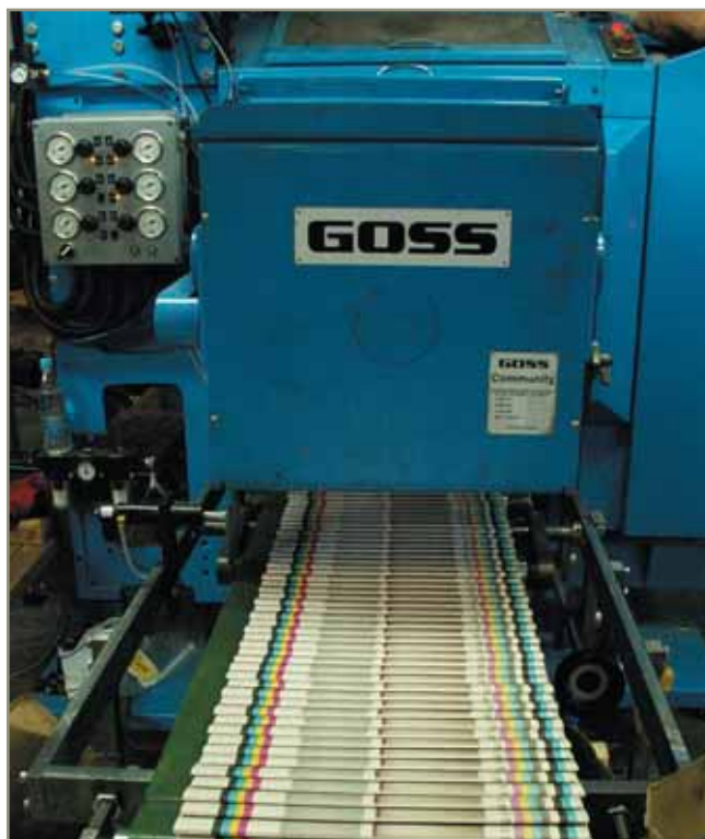
Устройство третьего ударного фальца на машине Goss Community
