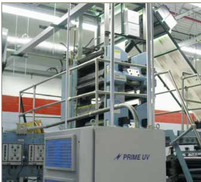
УФ-процессор от Prime UV на машине Goss Community
