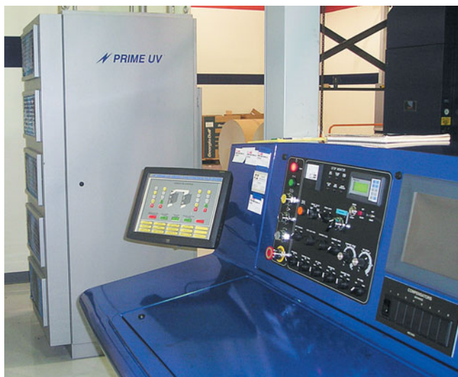
Рис. 3. Сенсорный монитор Prime smart system 2100, интегрированный в панель управления печатной машиной
