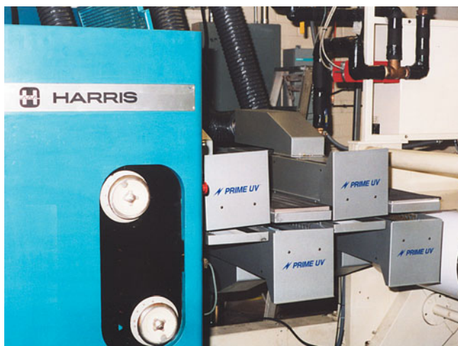
Рис. 5. Размещение УФ-сушки Prime UV Optimum на журнальных машинах
