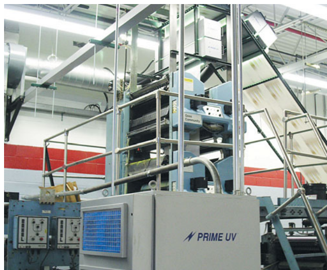
Рис. 4. Размещение УФ-сушки Prime UV Optimum на верхней части газетной машины
